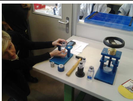
Machines pour l'ouverture des échantillons : Ancienne (à gauche) et nouvelle (à droite)
