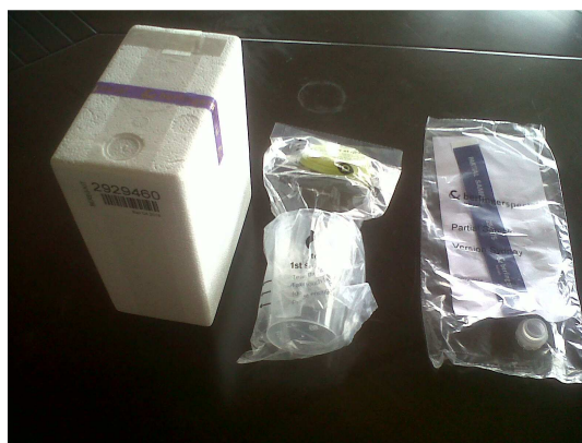
Matériel de prélèvement des échantillons. De gauche à droite : la trousse de prélèvement, le récipient de prélèvement et la trousse d'échantillon partiel
